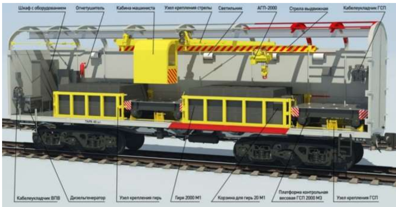
Рисунок 1 – Конструкция ВПВ-135К
