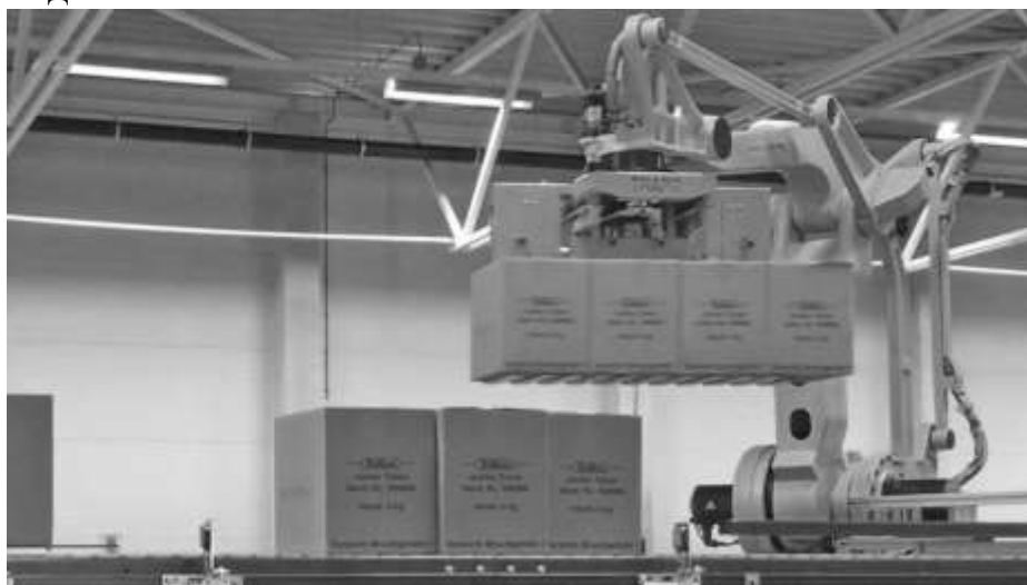
Рисунок 2– Захватное устройство от компании «Тгаро»
