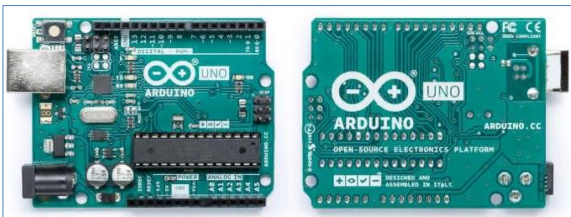
Рис. 1. Внешний вид платы контроллера ArduinoUno
