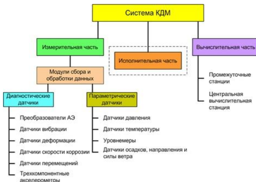
Рисунок 1. Обобщенная функциональная схема типовой системы КДМ технического состояния оборудования
