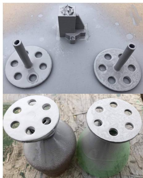
Рис.14. Нанесение грунтовки
