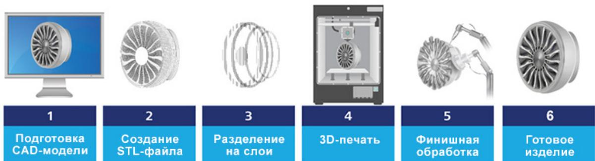
Рисунок 1. Последовательность аддитивного производства
