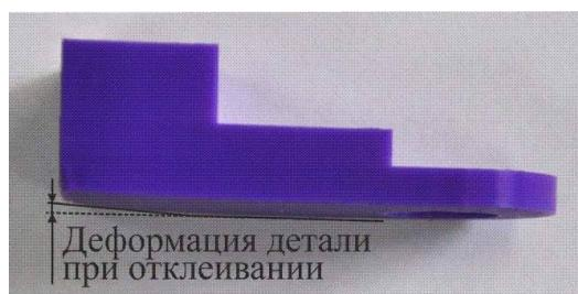
Рис. 5. Отклеивание и деформация угла печатаемой детали
