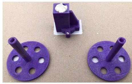
Рис.12. Фиксация деталей на подложке двухсторонним скотчем
