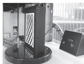
3 Дождитесь, когда в программе XYZscan отобразятся инструкции по установке калибровочной пластины. Установите пластину в центре поворотного стола (стороной с клетками к левому сканеру, поместив выступ на нижней части калибровочной пластины с отверстием в центре поворотного стола), а затем нажмите кнопку «Calibrate now» (Калибровать).
