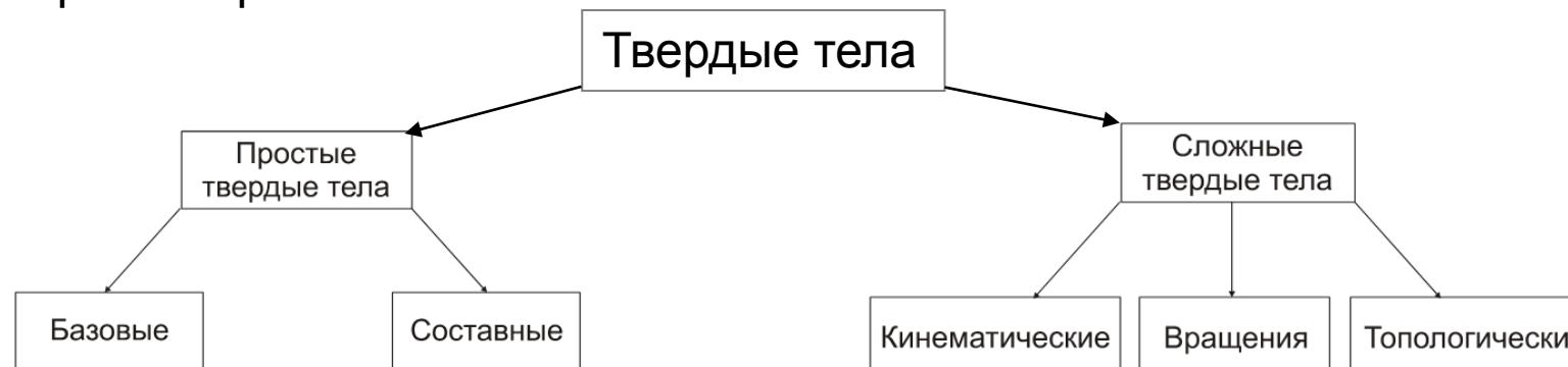
**Базовые тела** (твёрдотельные примитивы) – это параллелепипед, цилиндр, шар, конус и др.
