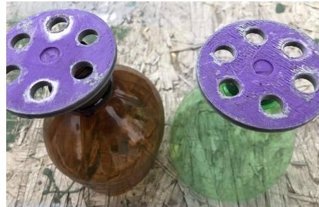
Рис.13. Размещение деталей в держателях (покраска верхней поверхности шкива)
